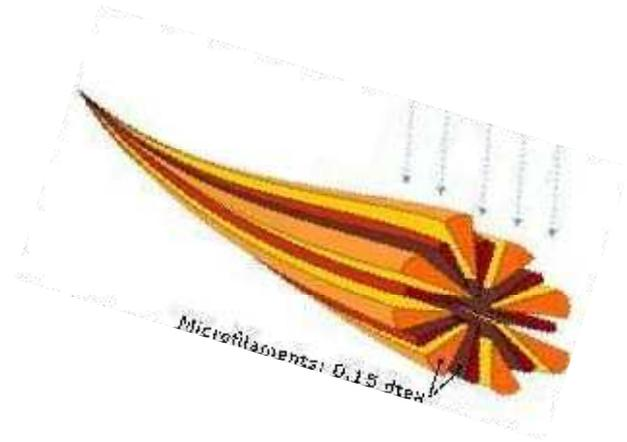
3. Mittels Hochdruck-Wasserstrahlen werden die Filamente zu Mikrofilamenten aufgesplittet.
